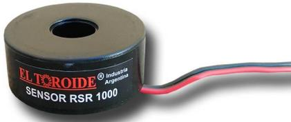
Los sensores de corriente ELTOROIDE son aptos para el sensado de corriente alterna en sistemas de medición y control, circuitos de protección, etc. El conductor se introduce a través del núcleo toroidal, constituyendo el circuito primario del transformador de corriente.
