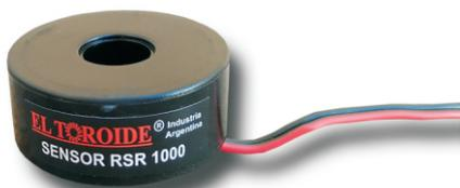
Los sensores de corriente ELTOROIDE son aptos para el sensado de corriente alterna en sistemas de medición y control, circuitos de protección, etc. El conductor se introduce a través del núcleo toroidal, constituyendo el circuito primario del transformador de corriente.
