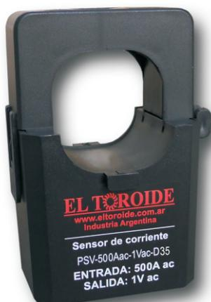
Los sensores modelo PSV-XXXAAC-1VAC-D35 entregan 1V de alterna cuando circule la corriente máxima por el centro del sensor. El sistema de núcleo partido con cierre fácil, permite utilizarlo en cualquier instalación sin necesidad de cortar el circuito.
